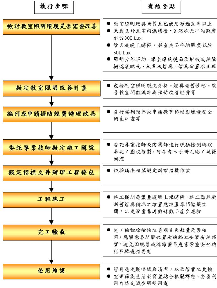
圖 5.2.30 照明節能改善施行步驟流程圖<sup>52</sup>
