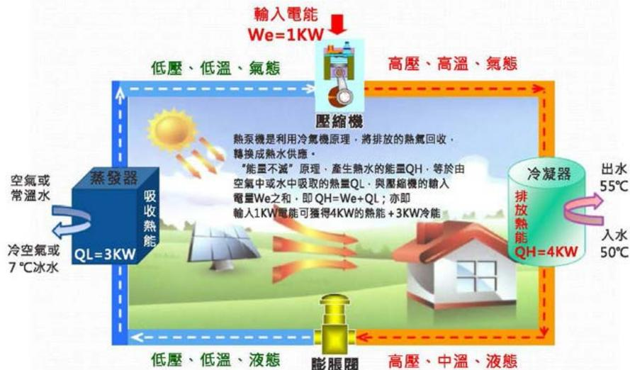
圖 3.1.1 熱泵系統原理<sup>1</sup>
